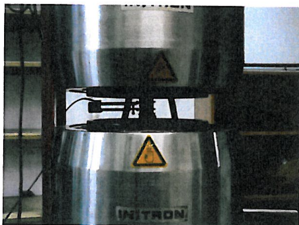
Fot nr: 7 Sposób mocowania próbki w uchwycie maszyny wytrzymałościowej wraz z przykładem typowego zniszczenia
