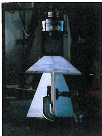
Fot. nr 2 Schemat obciążania próbek. Kształtownik ceowy (badany w zestawie)– schemat B
